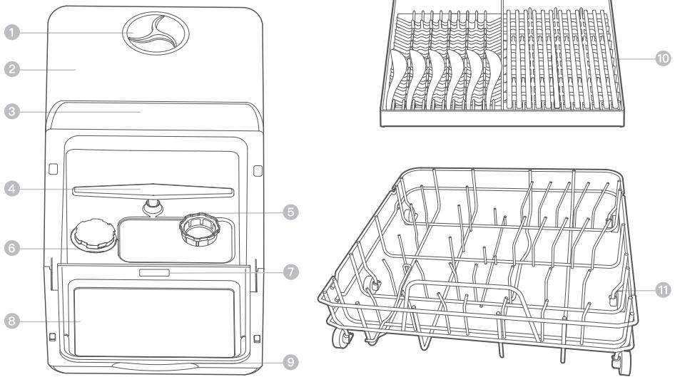
① 水箱加水口 ② 上蓋 ③ 觸控面板 ④ 噴臂 ⑤ 過濾器 ⑥ 軟水鹽/錠加入口
