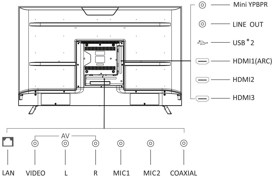
\* 因MIC輸入是採用類比訊號直接輸入，在插入設備、訊號傳遞到電視喇叭時，會有一聲爆音屬正常現象，請安心使用。建議您可以在關機時將設備先接好，再打開設備電源以降低爆音的聲量。
